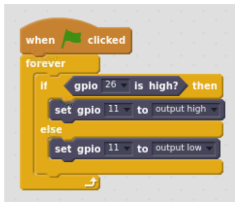
FIGURA 10 CITIREA STATULUI GPIO ÎN SCRATCH
