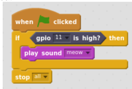
FIGURA 6 FOLOSIREA UNUI PIN GPIO DE INTRARE ÎN SCRATCH
