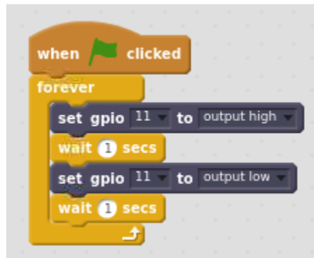
FIGURA 8 COMUTAREA STĂRII PIN GPIO ÎN SCRATCH
