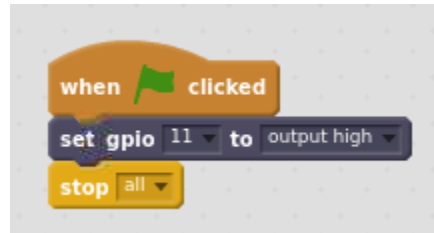
FIGURA 5 UTILIZAREA UNUI PIN GPIO DE IEȘIRE ÎN SCRATCH
