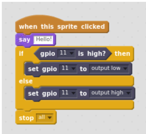
FIGURA 11 SPRITE FUNCȚIONĂND CA UN INTERRUPTOR CU DOUĂ STATE CITIND STATUL SĂU
