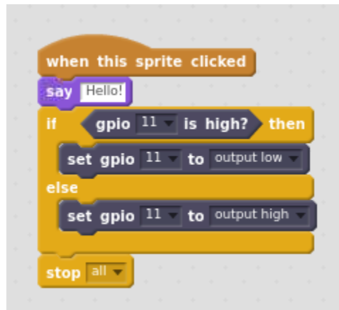
ΕΙΚΟΝΑ 11. ΤΟ ΑΝΤΙΚΕΙΜΕΝΟ ΔΡΑ ΩΣ ΔΙΦΑΣΙΚΟΣ ΔΙΑΚΟΠΤΗΣ «ΔΙΑΒΑΖΟΝΤΑΣ» ΤΗΝ ΙΔΙΑ ΤΟΥ ΤΗΝ ΚΑΤΑΣΤΑΣΗ
