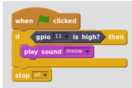
ΕΙΚΟΝΑ 6. ΧΡΗΣΗ ΜΙΑΣ ΑΚΙΔΑΣ ΕΙΣΑΓΩΓΗΣ GPIO ΣΤΟ SCRATCH
