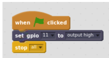
ΕΙΚΟΝΑ 5. ΧΡΗΣΗ ΜΙΑΣ GPIO ΑΚΙΔΑΣ ΕΞΟΔΟΥ ΣΤΟ SCRATCH
