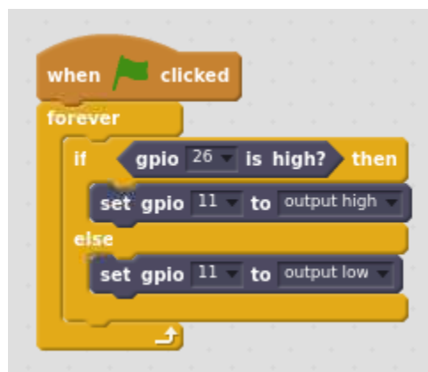
ΕΙΚΟΝΑ 10. «ΔΙΑΒΑΣΜΑ» ΤΗΣ ΚΑΤΑΣΤΑΣΗΣ ΤΟΥ GPIO ΣΤΟ SCRATCH
