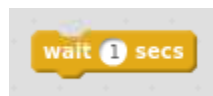
Imagem 2. Pausa da execução do código durante 1 segundo imediatamente antes de deixar o loop Fonte: Projeto STEMKIT4Schools
