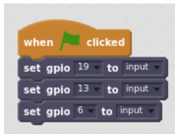
Imagem 3. Início do código - definição de pinos GPIO relevantes como pinos de entrada
