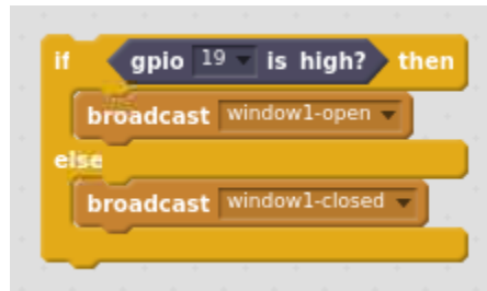
Obraz 6. Instrukcja odczytująca wartość GPIO i rozsyłająca komunikaty
