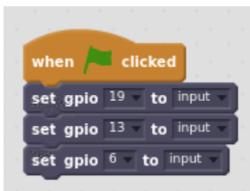
Obraz 3. Początek kodu - ustawienie odpowiednich pinów GPIO jako wejściowych Źródło: Projekt STEMKIT4Schools
