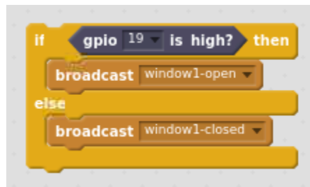
Εικόνα 6. Μια δήλωση if που διαβάζει την τιμή GPIO και μεταδίδει μηνύματα Πηγή: Έργο STEMKIT4Schools project
