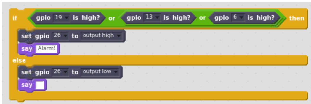
Εικόνα 7. Μια δήλωση if για ενεργοποίηση του συναγερμού, εάν χρειάζεται Πηγή: Έργο STEMKIT4Schools
