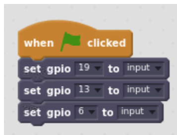
Imag. 3. Începutul codului - setarea pinilor GPIO relevanți ca intrări Sursa: STEMKIT4Schools project
