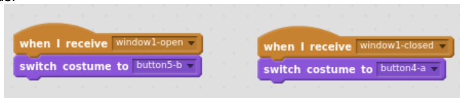
Image 2. Script pour les sprites réagissant aux lectures des broches GPIO Source: Projet STEMKIT4Schools
