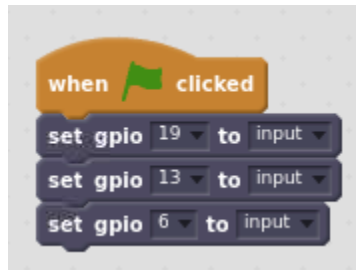
Image 3. Début du code - définition des broches GPIO pertinentes en tant que broches d'entrée Source: Projet STEMKIT4Schools
